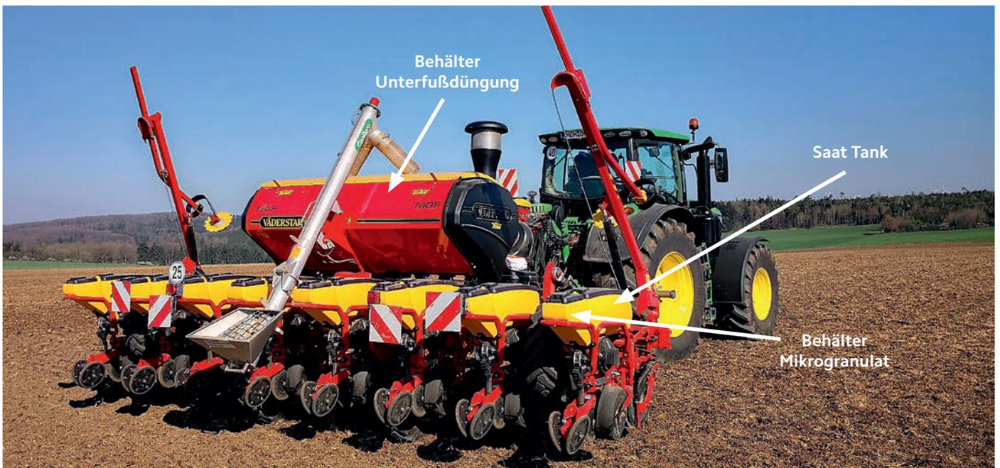
Väderstad Tempo F Einzelkornsämaschine mit Mikrogranulatstreuer
